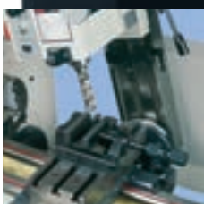
MOŻLIWOŚĆ ZAMONTOWANIA NA ŁOŻU POPRZECZNYM STOŁU DO FREZOWANIA
