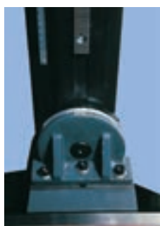
FREZARKĘ MOŻNA USTAWIĆ POD KĄTEM ± 45° W PŁASZCZYZNIE PODŁOŻNEJ STOŁU
