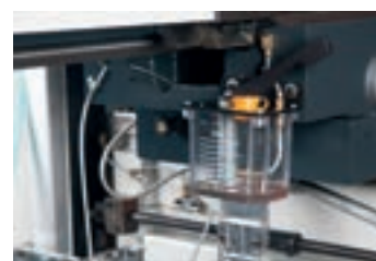
UKŁAD CENTRALNEGO SMAROWANIA
